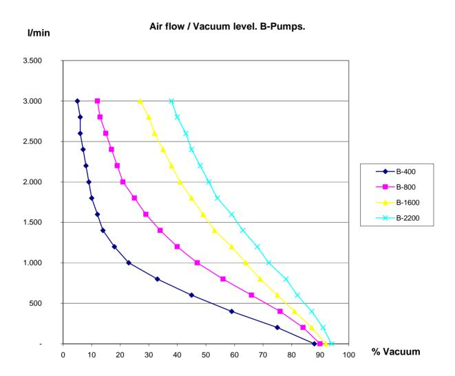
Litres / min. Rotor turning speed: 1.500 r.p.m.
